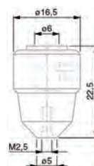
Axialer Messeinsatzhalter für Messeinsätze mit Gewinde M2,5
