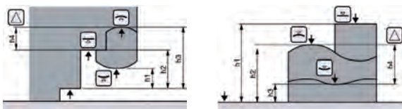
Messen ohne Wechsel der Messrichtung
