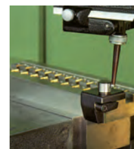
Beim Positionieren der Arbeitsspindelachse an der Werkzeugkante
